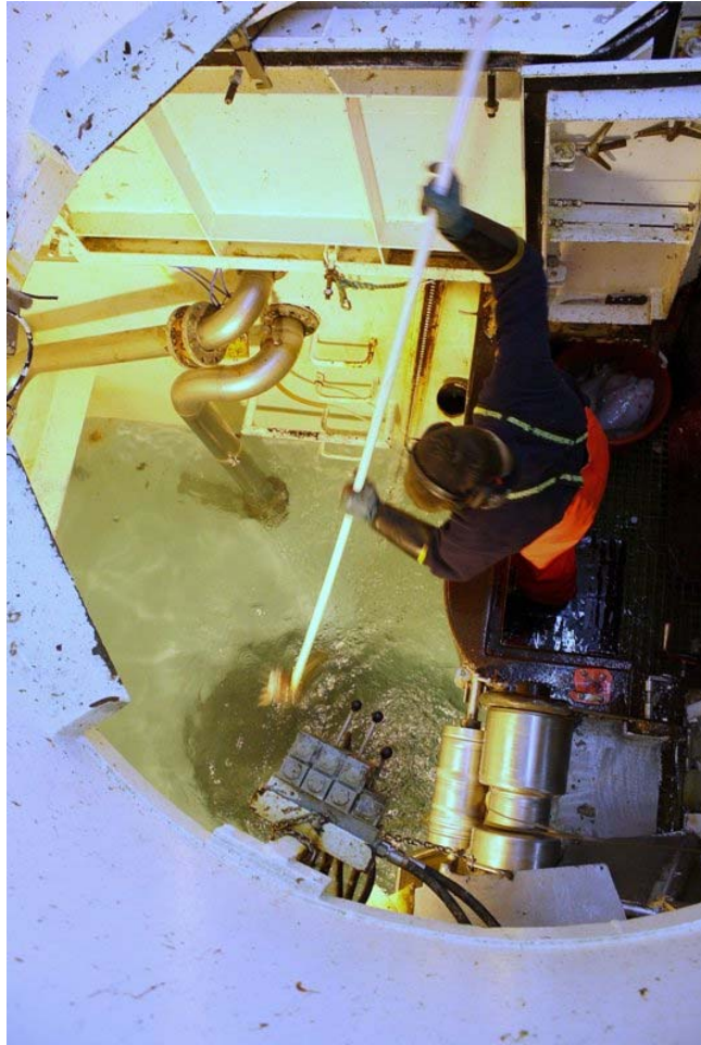
Foto 5 Vi ser ned i den vannfylte moonpoolen på F/L "Geir". Mannskapet bruker langkroken til å fange opp en fisk som har løsnet fra lina. (Foto: Gjermund Langedal)
