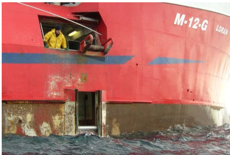
Foto 4 Inngangen til ALH sett i forhold til den gamle drageluka og rullen. Foto: I. Tatone
